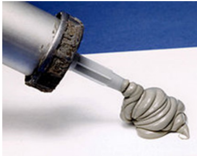
Şəkil 1: Suvaq tapançasından çıxan silikon
