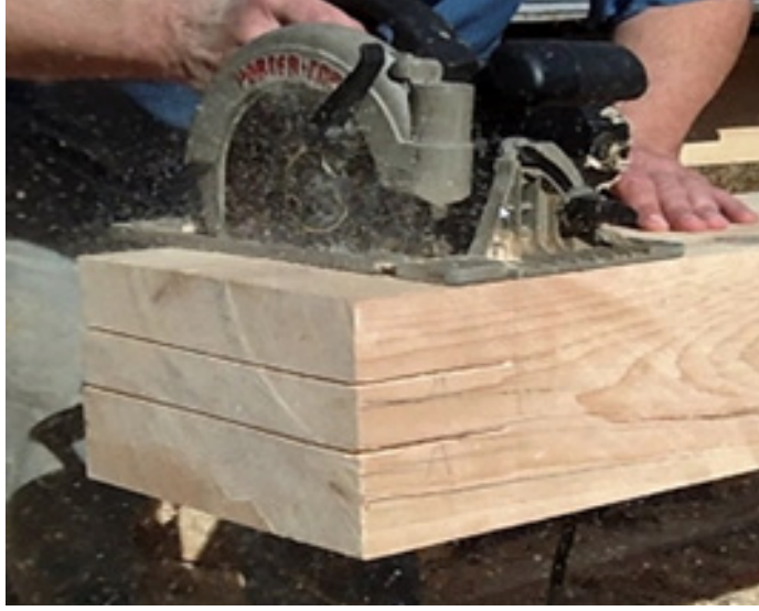
Şəkil 2: Çıxıntının qıraq hissələrinin kəsimi
