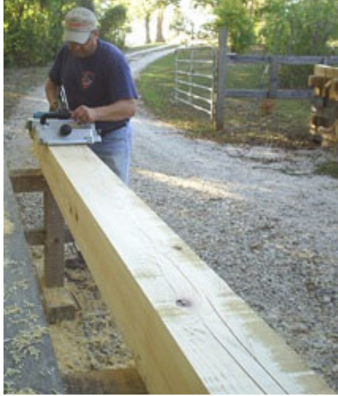
Şəkil 4: Mühərrikli rəndə ilə kəsim
