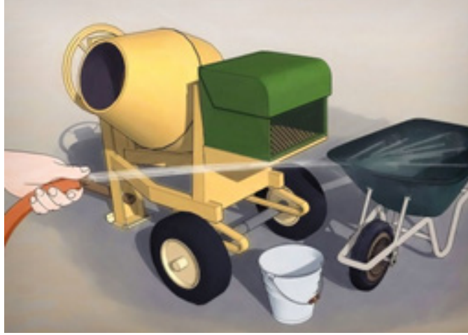
Şəkil 4: Qarışdırıcı və alətlərin yuyulması
