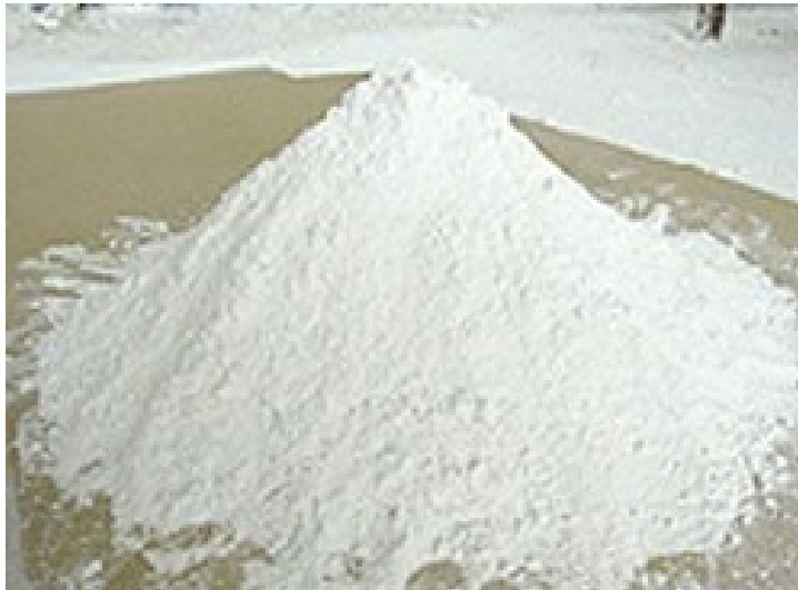
Şəkil 1: Gips əsaslı suvaq
