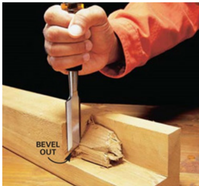
Şəkil 6: İskənə ilə kəsmə
