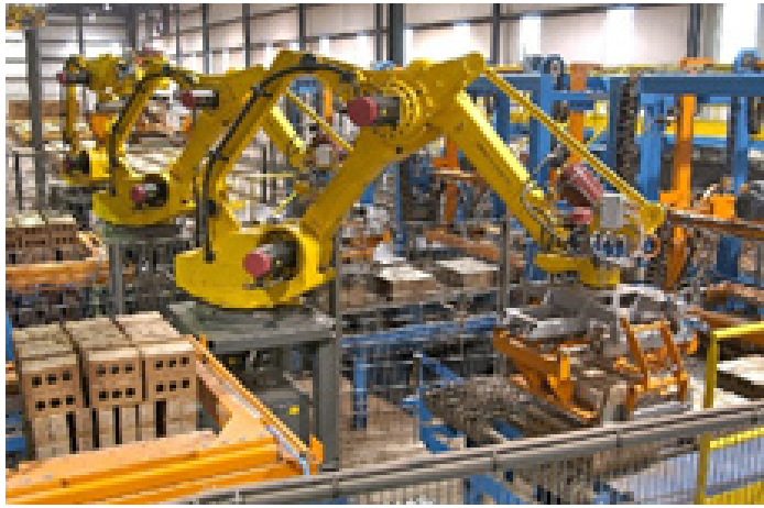
Şəkil 3: Bişmiş kərpicin robot tərəfindən sıxılıb çıxarılması
