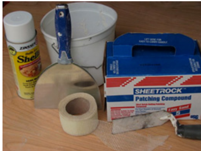
Şəkil 4: Tez bərkiyən yapışdırıcı maddə və alətlər
