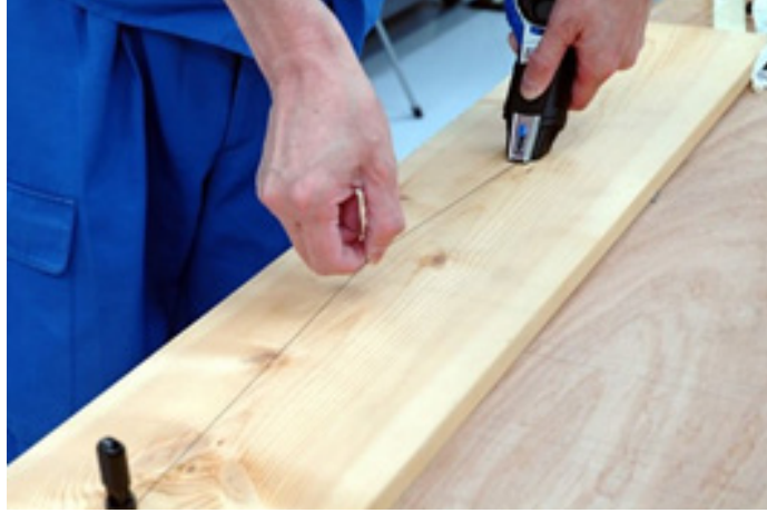
Şəkil 1: Tabaşir ipi ilə xətləmə
